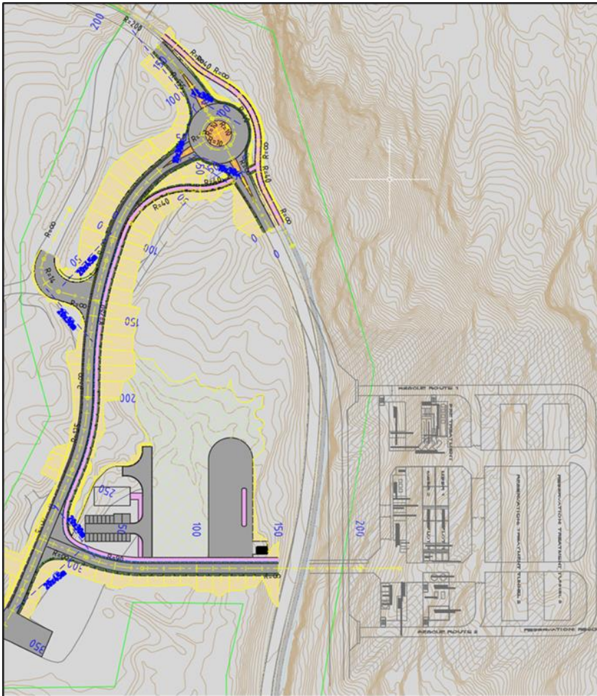
Figur 8: Plassering og utforming av renseanlegget med planlagt adkomstvei, servicebygg og plass for tunge kjøretøy.
