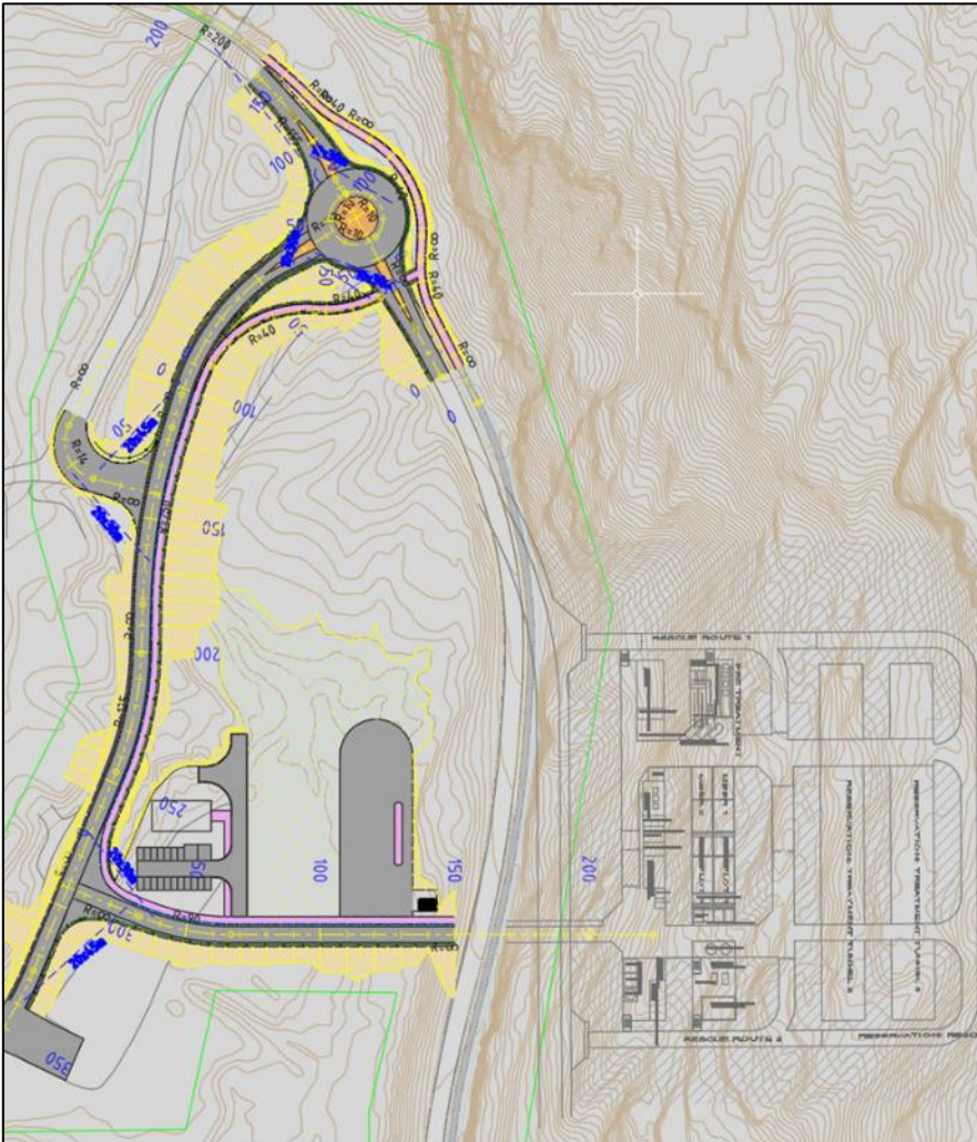
Figur 4: Plassering og utforming av renseanlegget med planlagt adkomstvei, servicebygg og plass for tunge kjøretøy.
