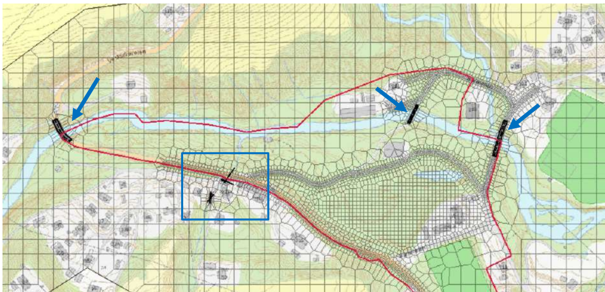
Figur 4-4. Rutenett i sentral del av modell/planområde. Bruer (markert med piler) er lagt inn med estimerte høyder og geometri. Kulverter oppstrøms/gjennom Vestsideveien (blå markering) er lagt inn med diameter 600 mm.
