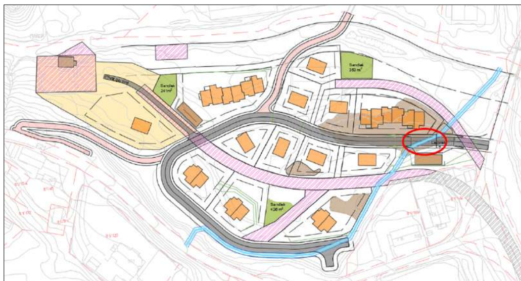
Figur 2-2: Eksisterende avrenningslinje krysser planlagt vei i punktet vist med rød sirkel.
