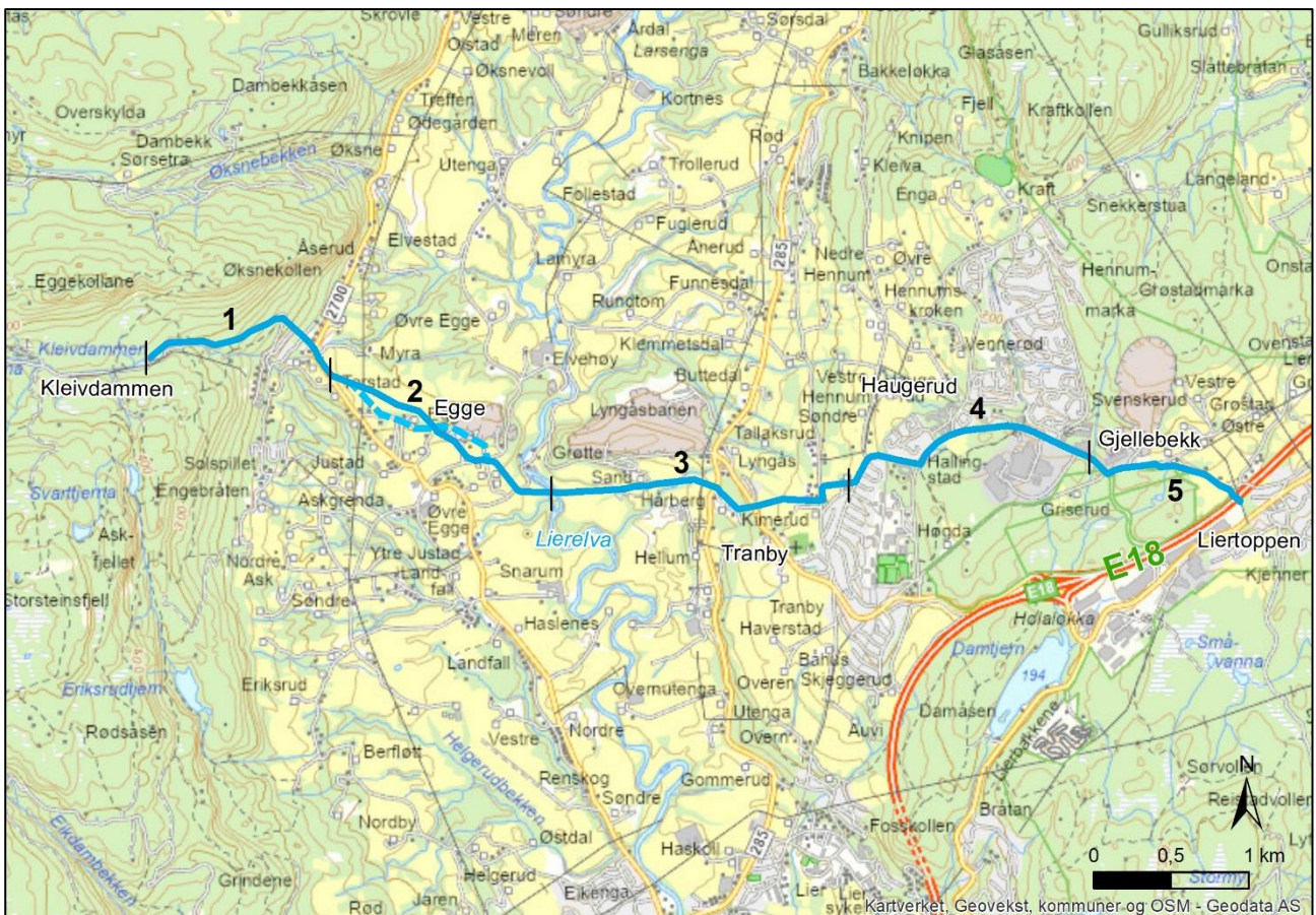
Figur 1-1. Oversiktskart for trase for ny vannledning. Traseen er delt inn i fem delstrekninger. Ved Egge vurderes to ulike varianter av traseen i tillegg til hovedalternativet.
