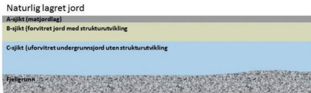
Figur 1-2. Prinsippkisse som viser oppbygging av jordprofilen før og etter jordflytting (Hauge & Haraldsen, 2017).
